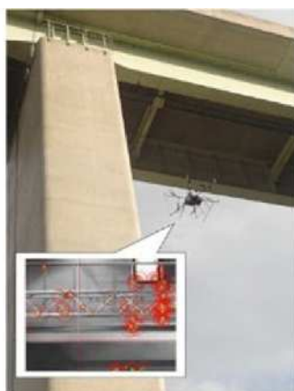
写真-1 非 GPS 環境対応型ドローン及びボールカメラ
