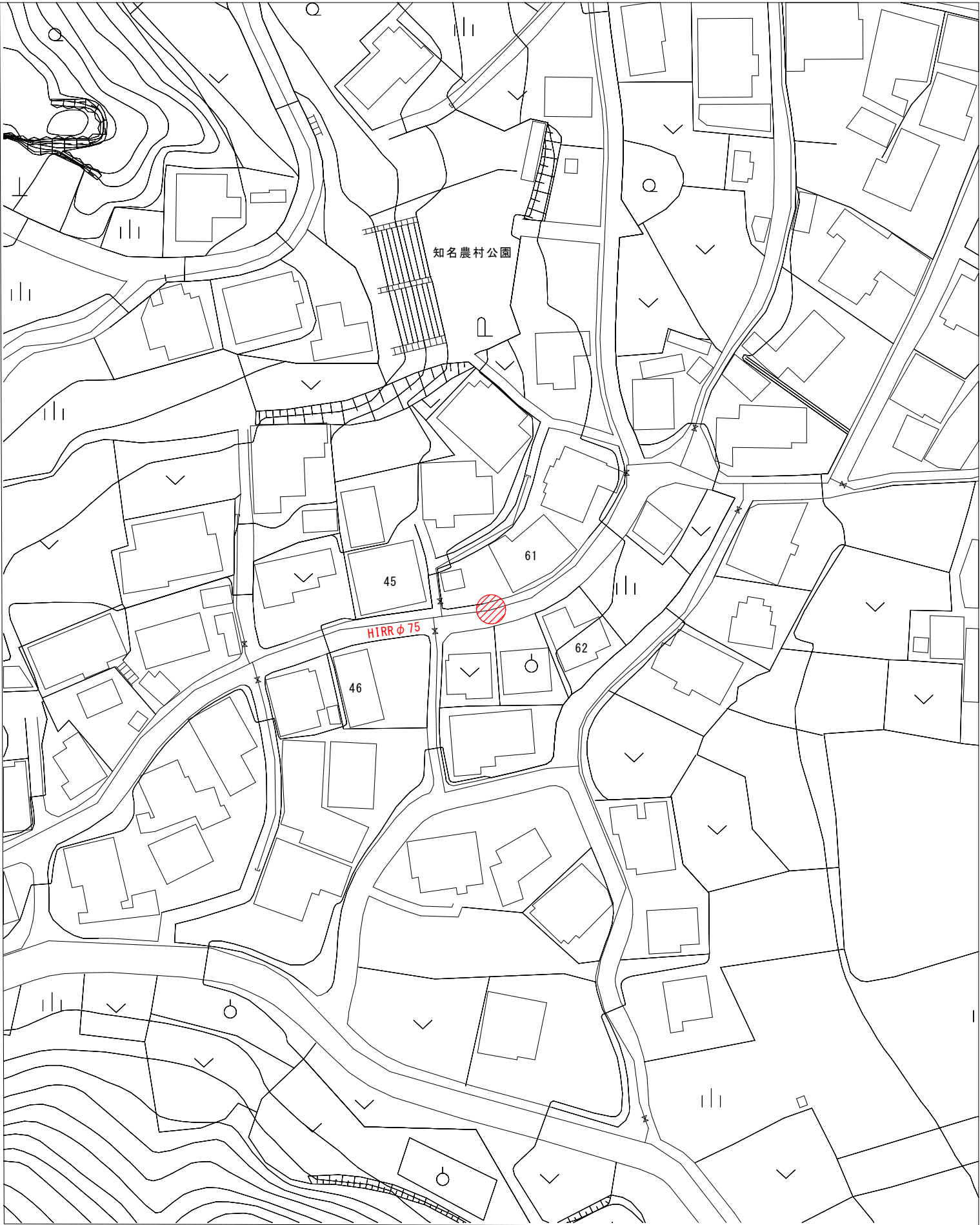
消火栓設置位置図（新設） S=1/1000
