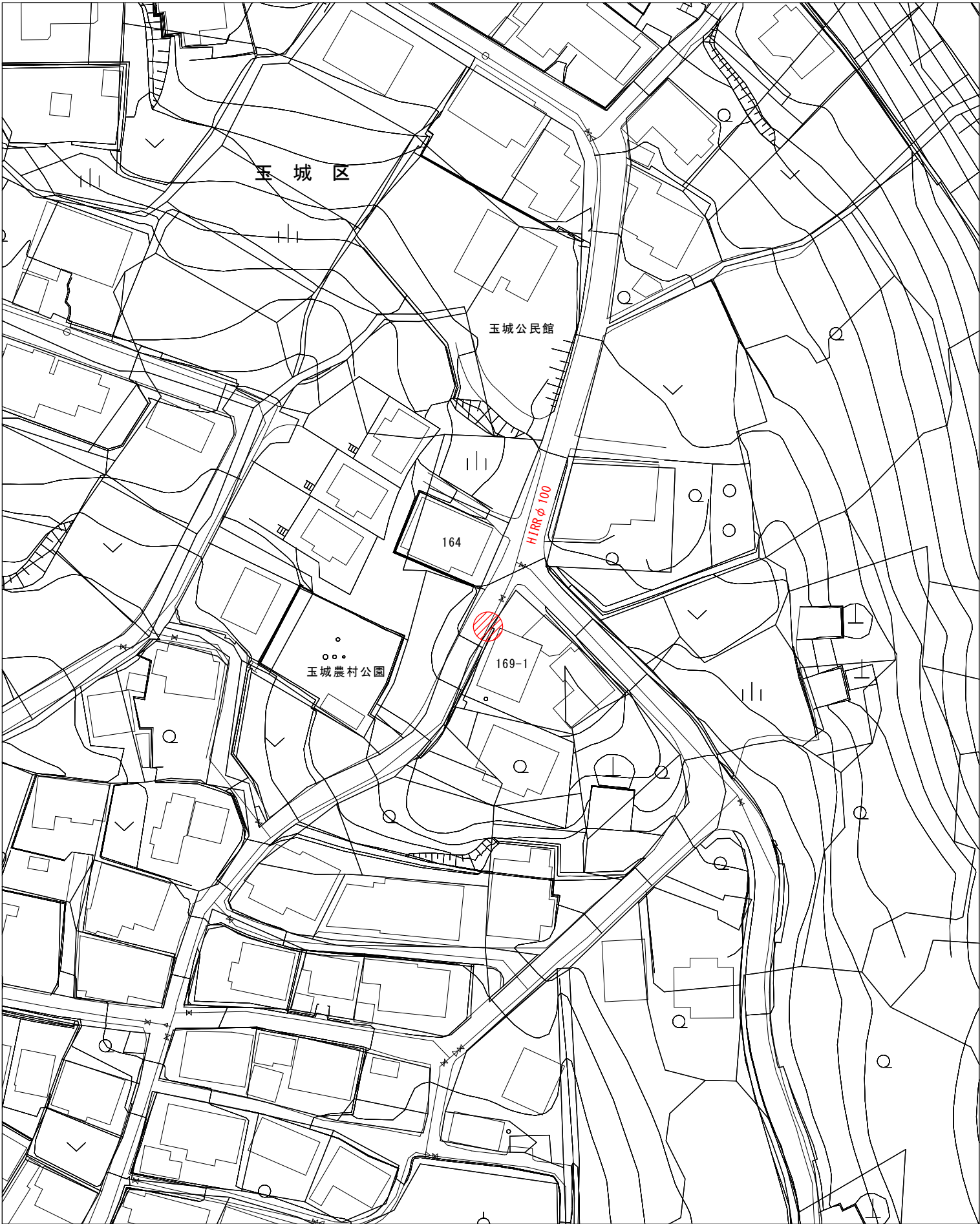
消火栓設置位置図（新設） S=1/1000
